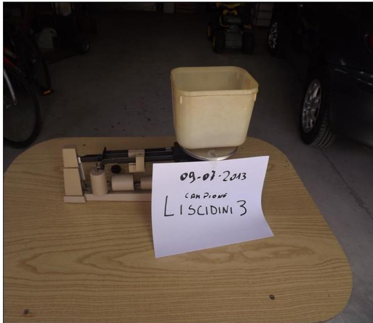
FOT. 5 - FASE DI PESATURA DEL CAMPIONE
