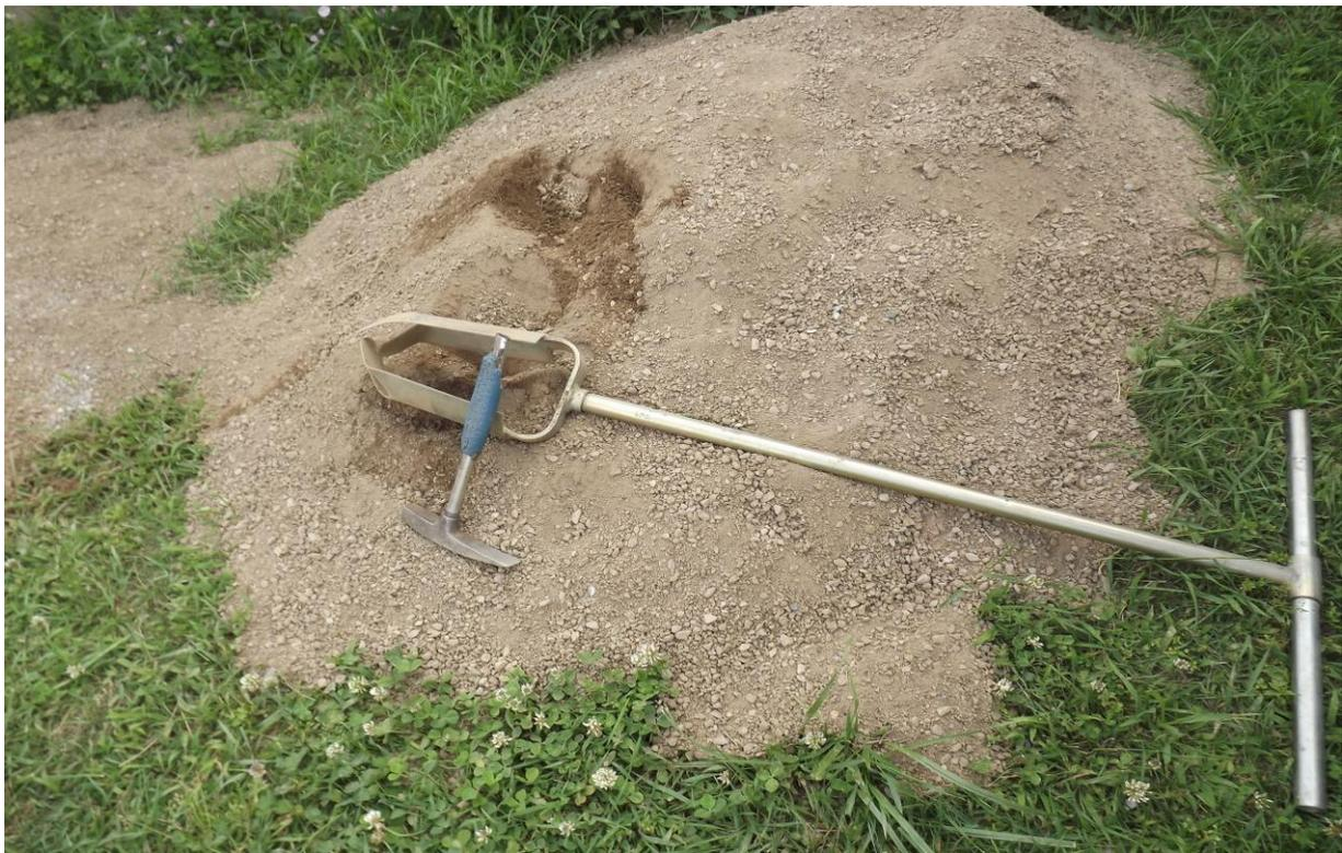
Foto 4 - Campionatore manuale da superficie per prelievo materiale incoerente in situ.
