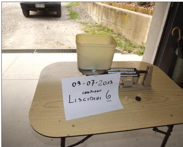
FOT. 11 - FASE DI PESATURA DEL CAMPIONE
