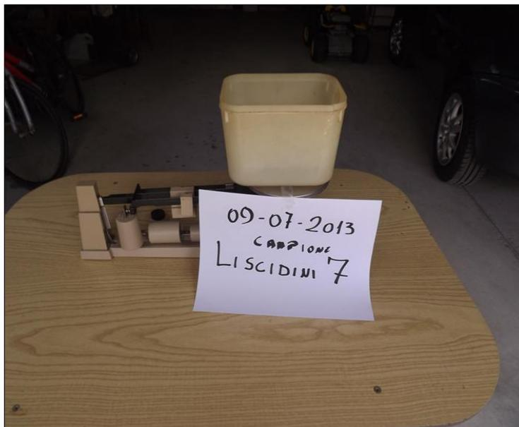
FOT. 13 - FASE DI PESATURA DEL CAMPIONE
